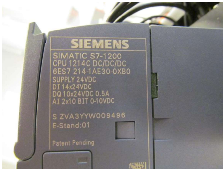
KUVA 3. Logiikan kyljessä on usein samassa paikassa kaikki tieto, mutta jos logiikka on jo kiinni keskuksessa, sitä harvoin pääsee lukemaan.
